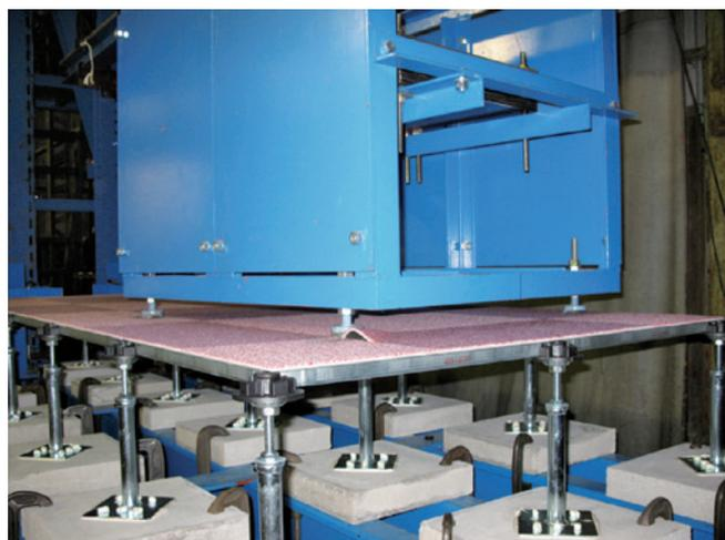
写真2 加振後の試験体状況
